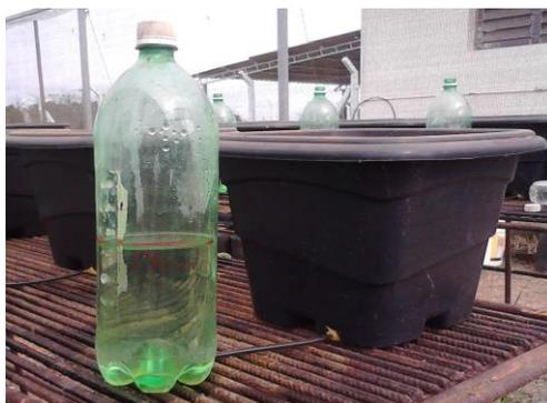
Figura 1. Detalhe do vaso conectado a garrafa PET por microtubo.
