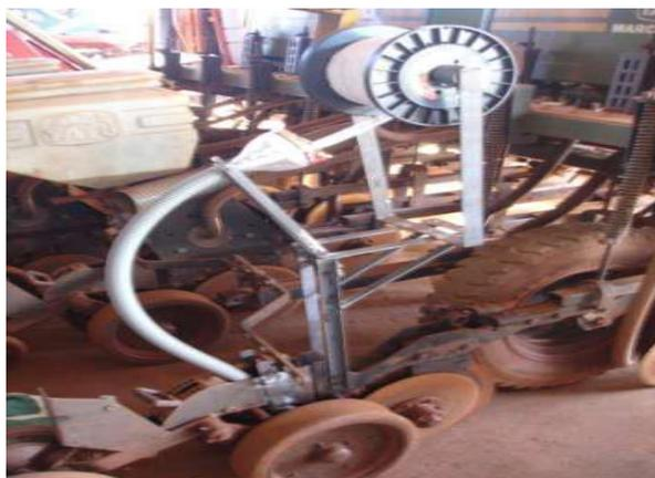
Figura 1. Protótipo de linha de semeadora equipada com sistema de disposição de sementes por fita.
