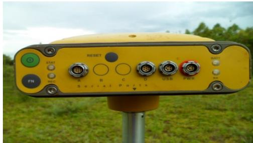
Figura 3 - GPS Hiper da Topcon *Positioning System*
