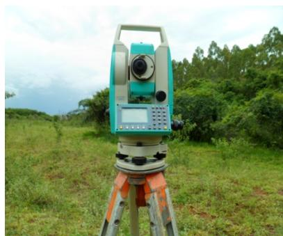
Figura 2 mostra a estação para o levantamento planimétrico da área.
