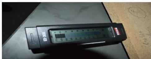
**Figura 1.** Medidor de umidade Instrutherm Modelo MUMC- 620
