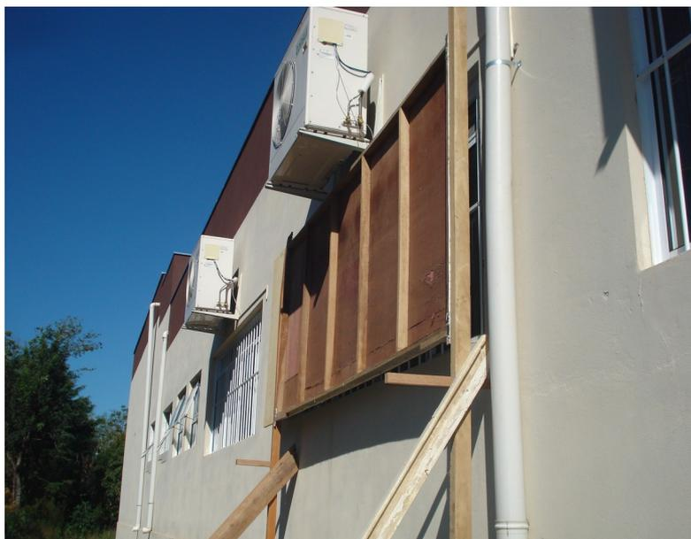
**Figura 1:** Tampão usado para simular um Brise
