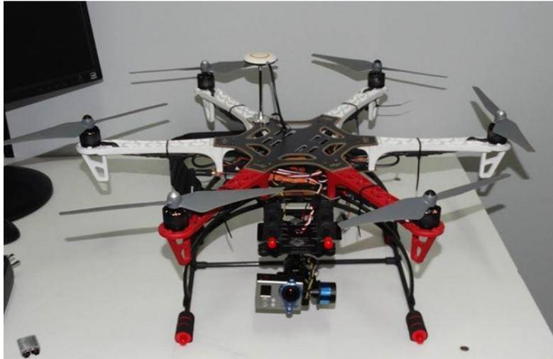
*Figura 1 - Hexacóptero Aerofotogramétrico*
