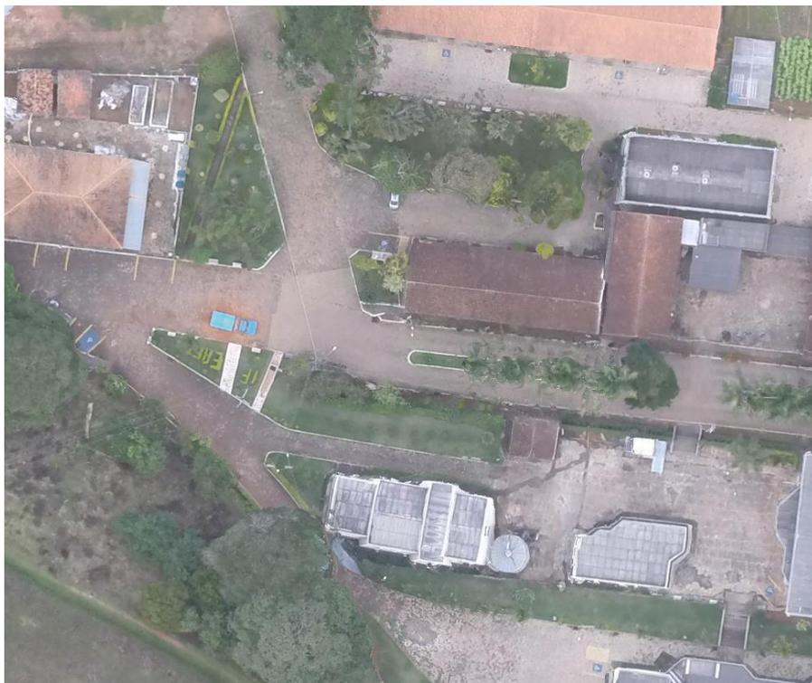
*Figura 3 - Mosaico obtido através do MDS no Photoscan*
