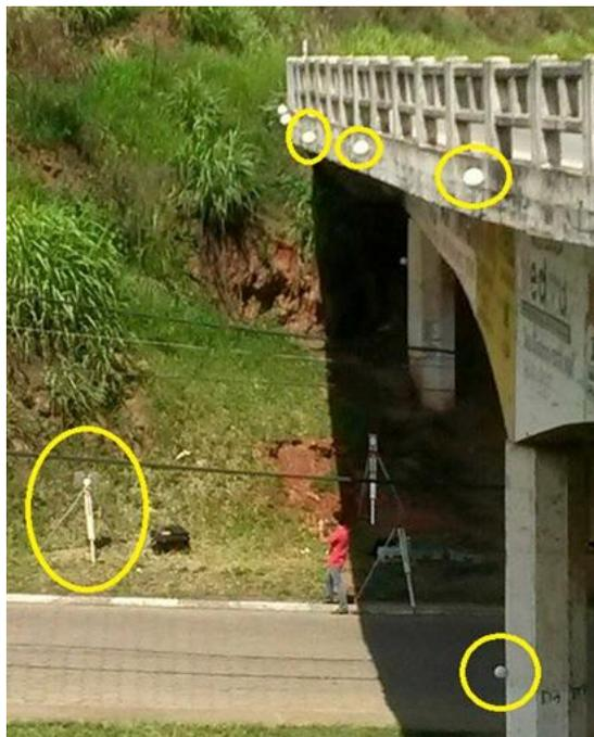
**Figura 1** – Ilustra a posição do Scanner e dos alvos no momento da coleta dos dados
