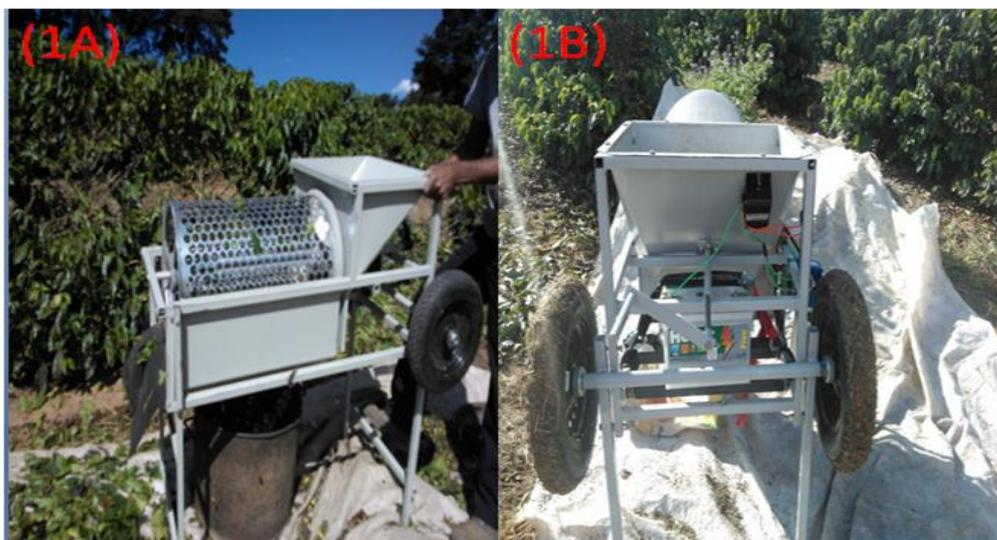
**Figura 1.** Protótipo de abanador; A: De acionamento manual; B: De acionamento elétrico.
