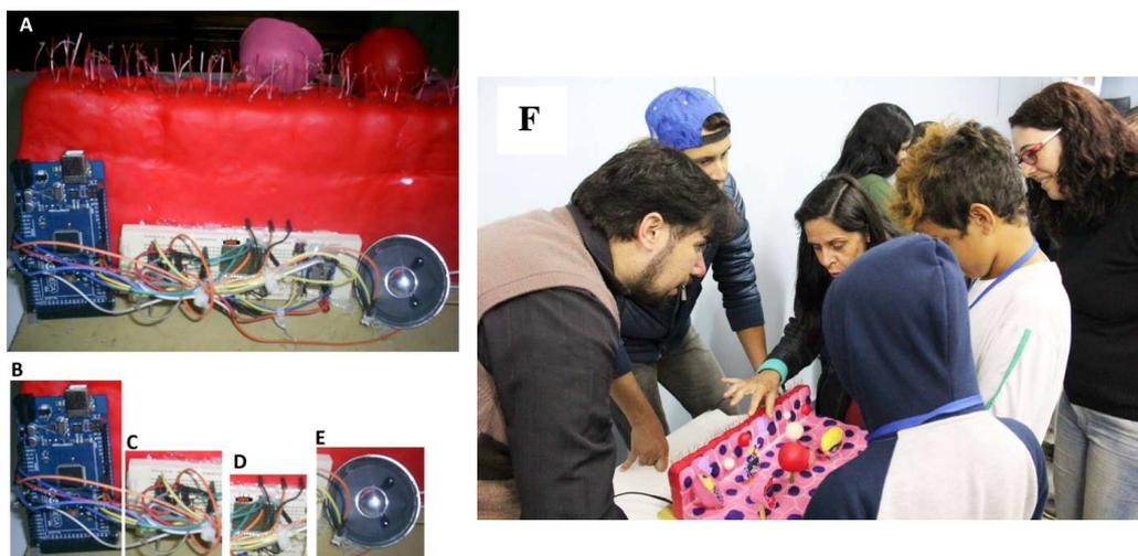
**Figura 2: Visão posterior do modelo didático confeccionado e utilização do material didático por pessoas com baixa visão.** **A.** Visão geral do circuito para emissão de som; **B.** Placa do Arduino Mega; **C.** Módulo MP3; **D.** Sensor; **E.** Auto Falante com amplificador; **F.** Utilização do material com alunos de baixa visão regularmente matriculados na educação básica.
