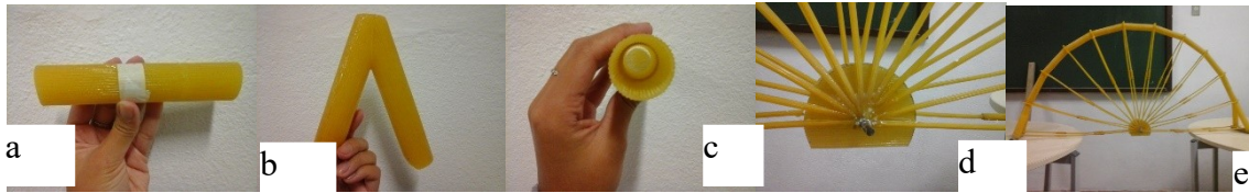
Figura 1- Etapas de confecção da ponte: a) e c) Barras de compressão, b) Bifurcação das barras de compressão, d) Colagem das Arestas no eixo central e e) Ponte já montada e pronta.
