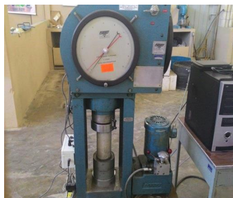
Figura 2 – Prensa hidráulica FORMEI FT-40DR realizando ensaio de resistência à compressão.
