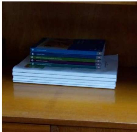
Para a validação do resultado obtido foi realizado a vetorização dos livros a partir da nuvem de pontos. Calculado o volume usando os polígonos vetorizados, comparou-o com o volume obtido pela subtração das superfícies. E para a verificação se o volume encontrado foi equivalente ao volume real, foram medidas as arestas dos objetos reais e calculados seus volumes.
