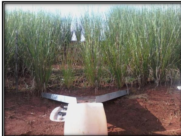
**Figura 1.** Calha e bomba de 50l em uma parcela do experimento, Inconfidentes/MG.
