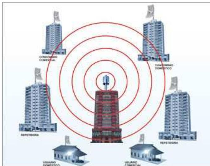
**Figura 2 – Estrutura de uma rede Outdoor multiponto**
