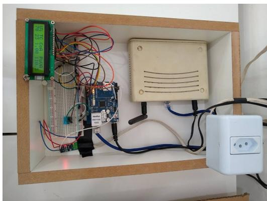
**Figura 2.** Protótipo do sistema de controle de demanda com o kit Arduino.
