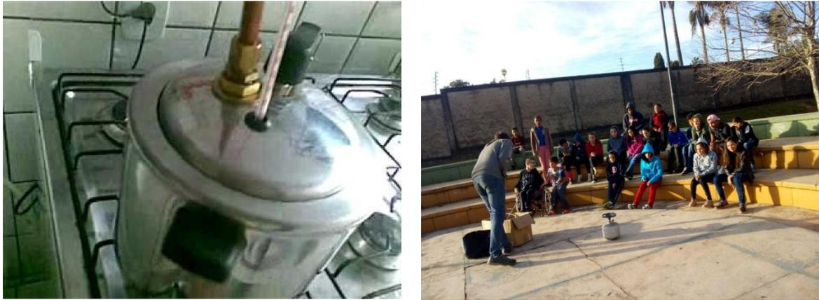
Figura 1. A. Destilador montado com materiais de baixo custo. B. Alunos observando a experiência.
