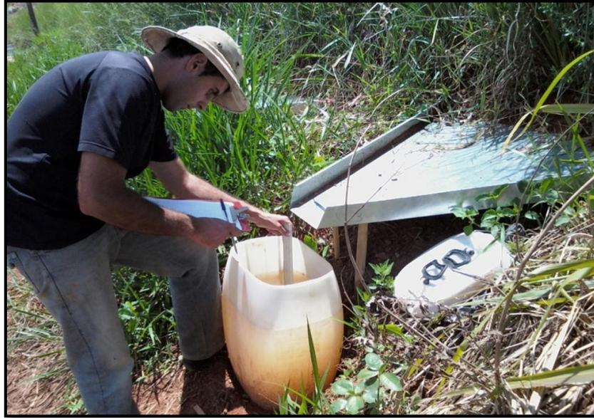
**Figura 1.** Medição do volume da solução escoada.
